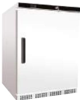
**Armoires positives :** Evaporateur type roll bond + ventilateur de brassage - Gaz réfrigérant R600 - Température de fonctionnement +2°C +8°C - Espacement entre les niveaux 70 mm - Dégivrage et réévaporation automatique - Isolation : 40 mm sans CFC.
