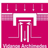
Durant le rinçage une partie de l'eau de la cuve est évacuée. Ce système de vidange évacue en priorité l'eau sale dans le fond de la cuve, permettant une économie d'eau et de produits lessiviels.
